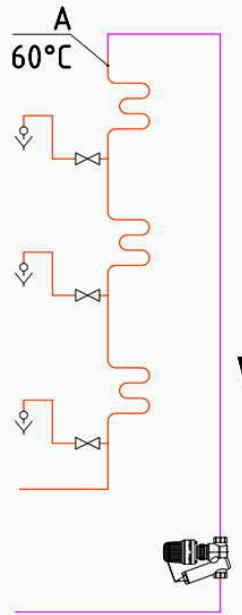
*В контрольной точке А должна поддерживаться температура 60°C. При расчетном циркуляционном расходе остывание воды на участке от точки А до клапана составляет 5°C. Клапан должен быть настроен на температуру: 60-5=55°C.*
